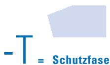
Schutzfasen vergrößern den Keilwinkel an der Schneide und führen, bei der Hartbearbeitung mit PCBN, zu einer stabileren Schneidkante. Der Schnittdruck wird dadurch erhöht.
