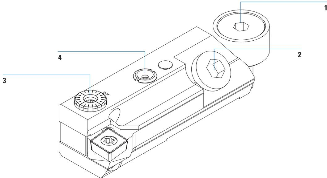
1. Axiale Verstellung (1 mm) über Keilelement
