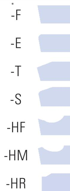
PCBN- und PKD/CVD-Diamant-Schneidstoffe sind ultraharte Materialien, die auch eine spezielle Schneidkantenausführung benötigen. Für die Stabilität und Standzeit der Schneide ist es deshalb von entscheidender Wichtigkeit, dass die Schneidkantenausführung der Schneidplatte dem Werkstück/Werkstoff und der Bearbeitungsaufgabe angepasst wird.
