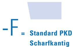
Bei einer Bearbeitung von Aluminium und anderen Nichteisenmetallen empfiehlt sich beim Einsatz von PKD eine scharfkantige, positive Schneide. Dadurch werden Schnittdruck und Aufbauschniede deutlich verringert.
