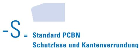
Bei einer sehr stark beanspruchten Schneidkante und stabilen Bearbeitungsbedingungen hat sich die Kombination von Schutzfase und Kantenverrundung bewährt. Ohne die Fase zu vergrößern, wird die Schneide durch die Verrundung zusätzlich vor Ausbrüchen geschützt.
