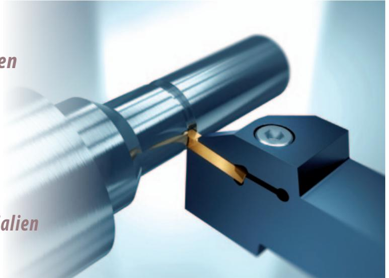
Unter Hartbearbeitung versteht man das Bearbeiten von gehärteten Materialien ab einer Härte von 54 HRC (Härte nach Rockwell). Bei der Zerspanung treten Kräfte auf, die hohe Anforderungen an Werkzeug und Beschichtung stellen.
