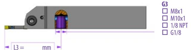
Die IK-Sonderlösung umfasst 1 Seitenanschluss und 1 Anschluss von hinten mit dem gleichen Gewinde inkl. 1 Verschlussstopfen.
