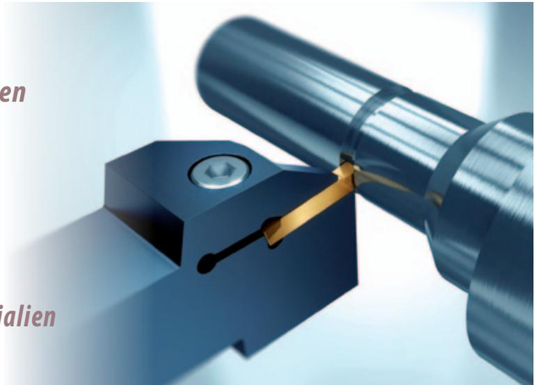
Unter Hartbearbeitung versteht man das Bearbeiten von gehärteten Materialien ab einer Härte von 54 HRC (Härte nach Rockwell). Bei der Zerspangung treten Kräfte auf, die hohe Anforderungen an Werkzeug und Beschichtung stellen.
