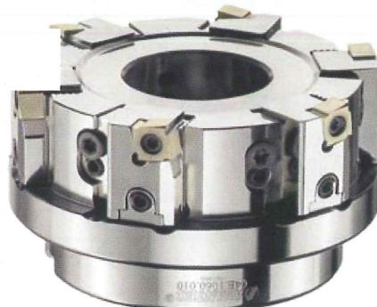
Kotoučové frézy AVANTEC představují špičku mezi tímto typem nástrojů. Vyrábí se v provedení s klasicky uloženou destičkou trojúhelníkového tvaru (v rozměrech od 63 do 250 mm) nebo tangenciálně uloženou destičkou se čtyřmi řeznými hranami (průměry od 125 do 250 mm). Díky střídavému uspořádání destiček (v každém nástroji jsou levé a pravé) mají tyto frézy velmi klidný řez.
